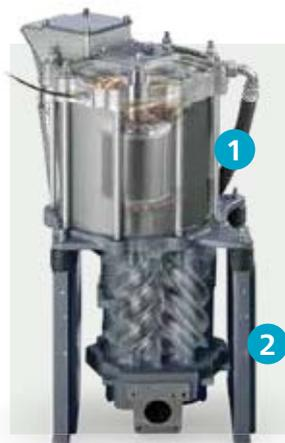
Благодаря двигателю с постоянным магнитом iPM (1), обновленному компрессорному элементу (2) и инновационному клапану загрузки компрессора, удалось увеличить энергоэффективность машин серии GA VSD+ по сравнению с поколением установок VSD. Так, показатели производительности сжатого воздуха (FAD) увеличились на 9%, что позволяет получить на 9% больше сжатого воздуха, а удельное энергопотребление (SER) снизилось на 9%, обеспечивая тем самым сокращение затрат на электроэнергию.
