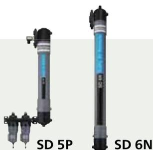
По мере прохождения сжатого воздуха через мембрану, влага отводится сквозь ее стенки. Часть осушенного сжатого воздуха движется между волокон мембраны навстречу основному потоку. Это позволяет выводить скопившуюся влагу из мембраны, тем самым поддерживая ее работоспособность.
