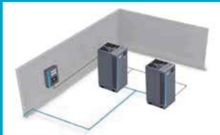
Контроллер EQ 4.0 настенного крепления предназначен для одновременного управления двумя компрессорами, каждый из которых может быть с частотно-регулируемым приводом (VSD). EQ 4.0 поддерживает частоту вращения электродвигателя каждого из VSD компрессоров в оптимальном для него режиме.
