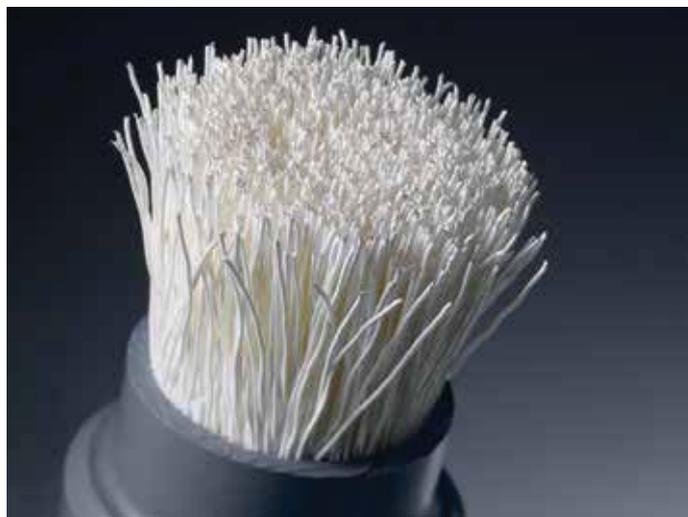
Мембрана состоит из группы полых волокон, имеющих полимерную структуру. По мере прохождения сжатого воздуха через мембрану, молекулы кислорода проходят сквозь ее стенки, а молекулы азота, имеющие больший размер, двигаются дальше. Часть азота, полученного после прохождения через мембрану, направляется между волокнами, навстречу основному потоку. Это позволяет выводить скопившиеся молекулы кислорода из мембраны, поддерживая ее работоспособность.
